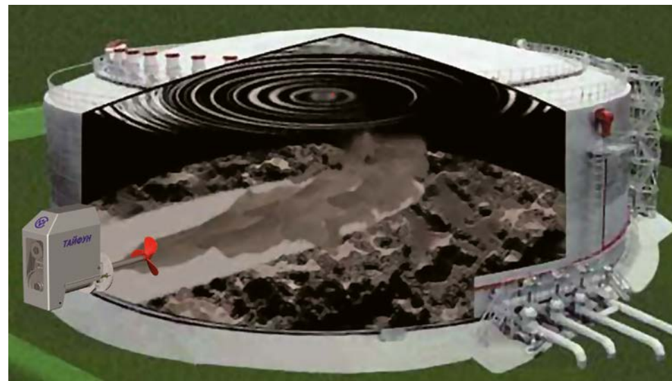
Процесс размыва донных отложений в резервуаре с нефтью.
